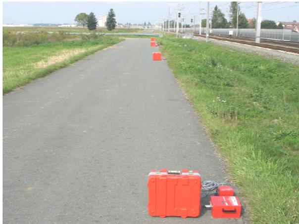
**Bild 5-6** Messpunktanordnung der Messreihe 1 - Kalsdorf parallel zu den Gleisen
