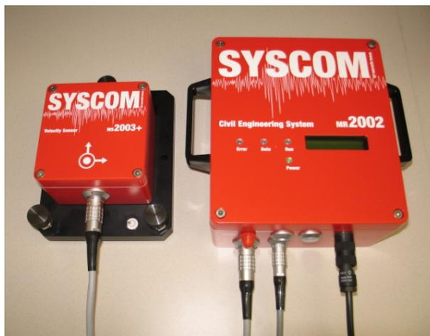
**Bild 5-1** Messgerät MR 2002 von SYSCOM mit triaxialem Geschwindigkeitssensor
