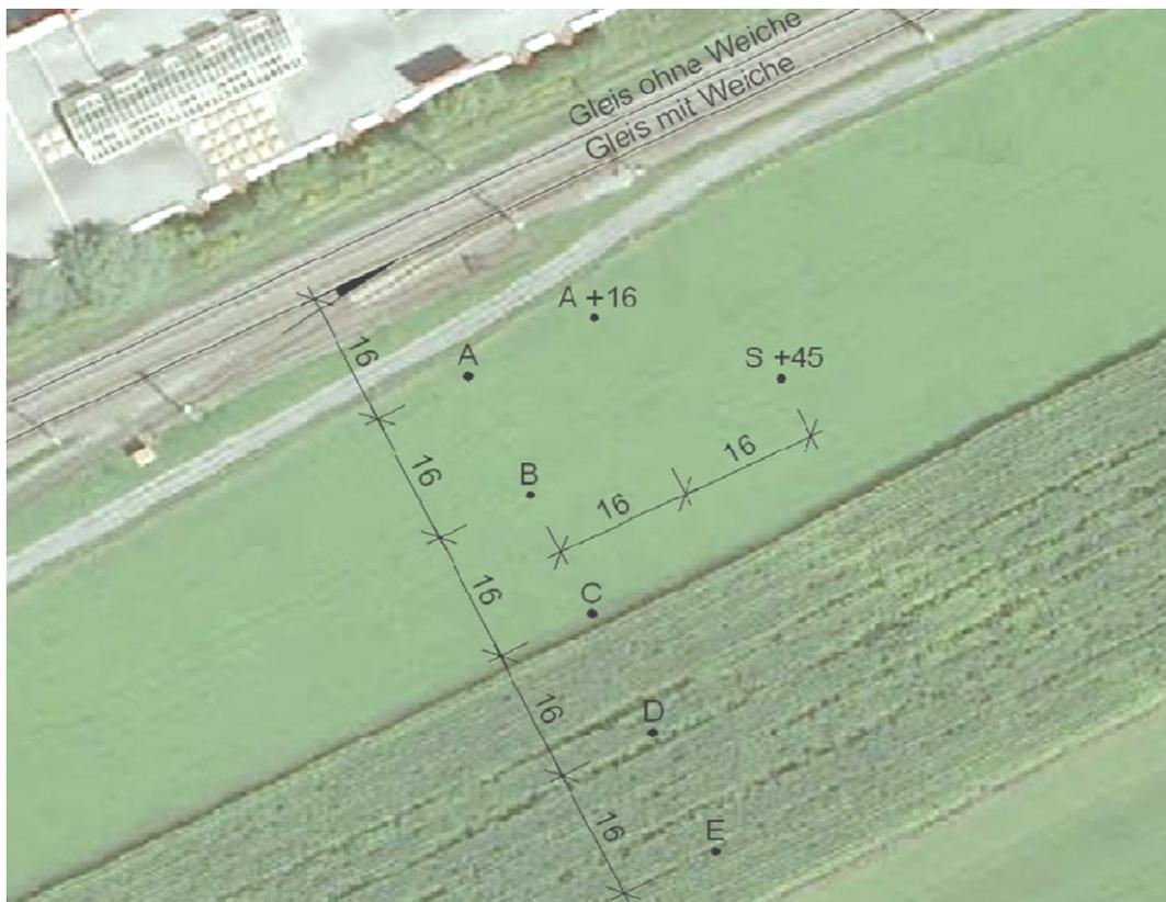
**Bild 5-20** Messpunktanordnung im Bereich der Messreihe 4 - Leoben (Quermessung)
