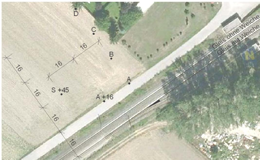
**Bild 5-10 Messpunktanordnung im Bereich der Messreihe 2 - Eggendorf (Quermessung) vgl. [ 21 ]**
