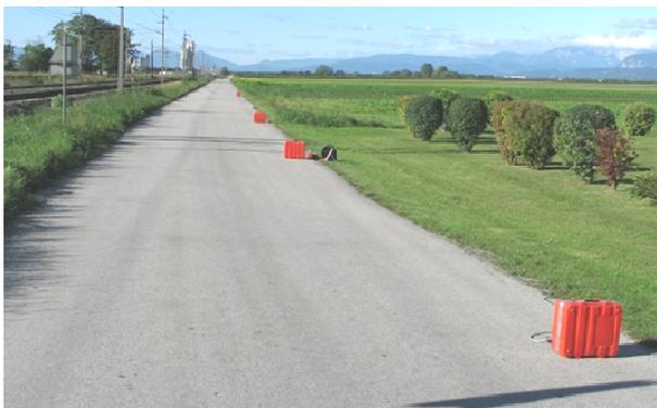
**Bild 5-11** Messpunktanordnung der Messreihe 2 - Eggendorf parallel zu den Gleisen
