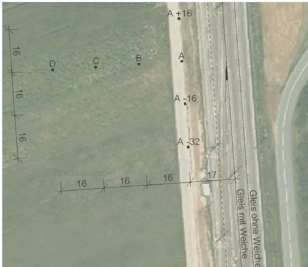
**Bild 5-5 Messpunktanordnung im Bereich der Messreihe 1 - Kalsdorf vgl. [ 20 ]**
