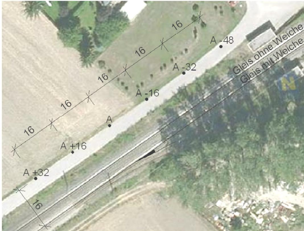
**Bild 5-9 Messpunktanordnung im Bereich der Messreihe 2 - Eggendorf (Parallelmessung) vgl. [ 21 ]**
