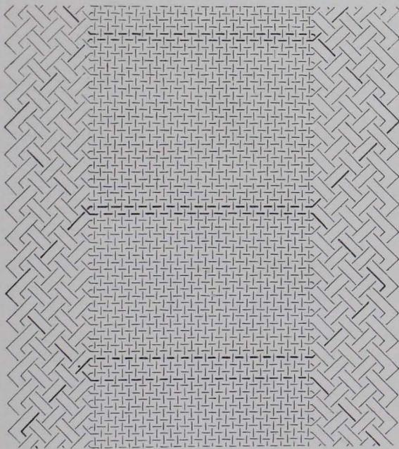
Fig. 46 Schema der Bindung des Gewebes Fig. 45.
