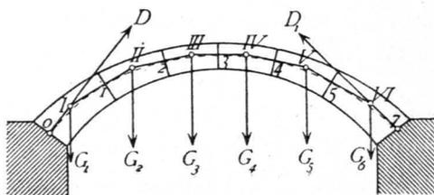
welches man das Resultantenpolygon nennt. Aus dem Resultantenpolygon ergibt sich sofort die Stützlinie, wenn man die Schnittpunkte der einzelnen Resultanten mit den bezüglichen Querschnitten, d. h. die Punkte *o*, *1*, *2*, *3*, *4*, *5* und *7* mit einander verbindet. Je kleiner die einzelnen Theile des Ge-
