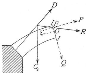
Betrachtet man etwa denjenigen Gewölbetheil, welcher zwischen dem linken Widerlager und dem Querschnitt *II* liegt, so sei diese Resultirende gleich *R*. Damit Gleichgewicht vorhanden sei, müssen im Querschnitt *II* eine Anzahl innerer Kräfte wirken, deren Resultirende gleiche GröÙe, gleiche Richtung, gleichen Angriffspunkt und entgegengesetzten Sinn hat, wie die Kraft *R*. Mit der Kraft *R* kennen wir also auch die Resultirende der hier thätigen inneren Kräfte. Zerlegt man *R* in eine
