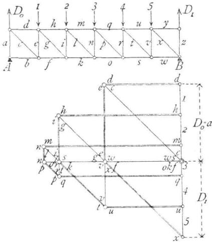
Wenn die Zeichnung für eine Belastung  $g$  pro Längeneinheit construiert ist, so geben die Längen der einzelnen Linien auch zugleich die Beanspruchungen für die Belastung  $p$  pro Längeneinheit, falls dieselben nur auf einem Maßstabe abgegriffen werden, auf welchem diejenige Länge  $p a$  bedeutet, welche vorher  $g a$  bedeutet hatte.
