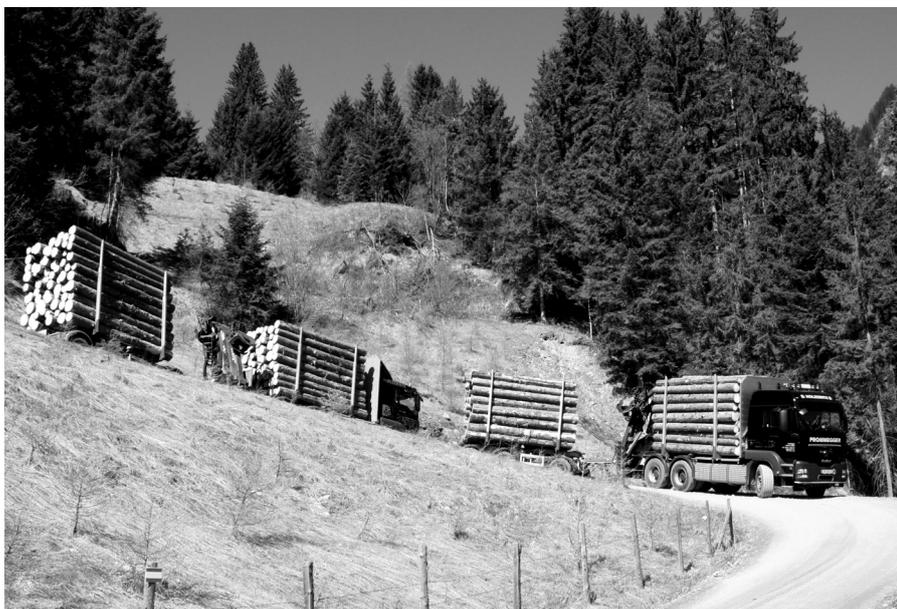
ABB.2: ABTRANSPORT VON RUNDHOLZ MITTELS RUNGEN LKW UND ANHÄNGER
