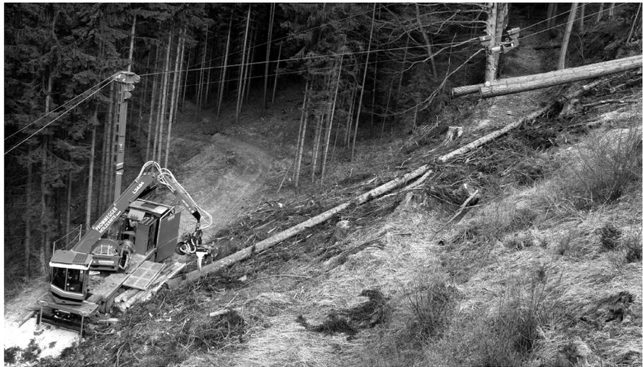
ABB.1: HOLZERNT MITTELS SEILKRAN (1000 M SEILLÄNGE UND 3 T NUTZLAST)
