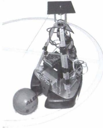
Der wichtigste Sensor unserer Roboter ist die omni-direktionale Kamera. Sie ist von unten auf einen gekrümmten Spiegel gerichtet und kann daher 360° überblicken. In diesem Bild versucht der Roboter, den Ball, die Linien des Spielfeldes und die anderen Roboter zu erkennen.
